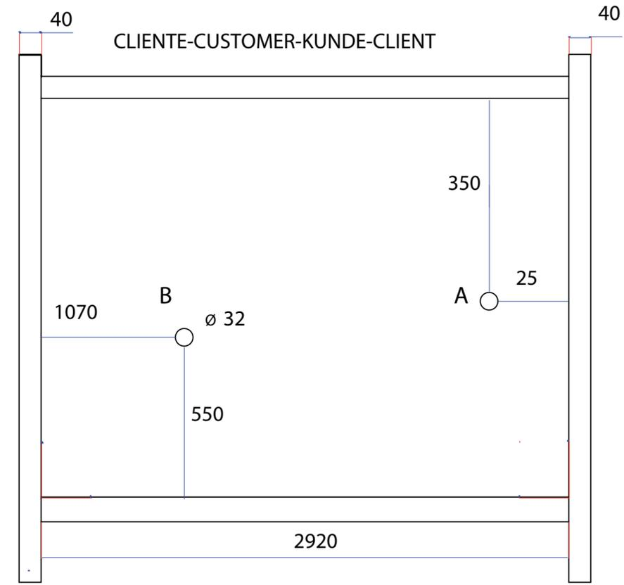
**A= SCARICO - OUTLET - ABLAUF - DECHARGE (Ø 32) .**
